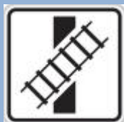
E10 Tvar křížení pozemní komunikace s dráhou
