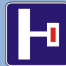
IP 5: návěšť pred slepou pozemnou komunikáciou
